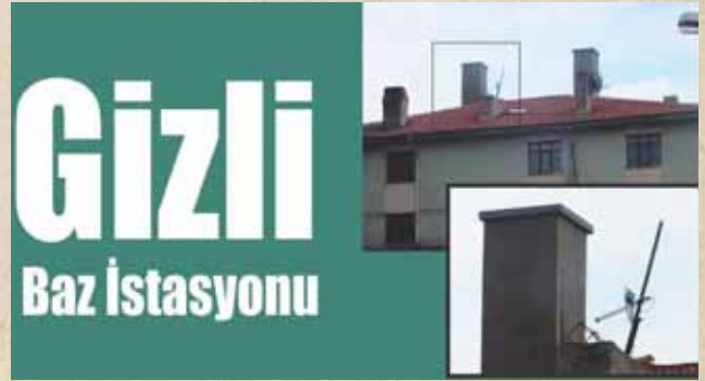
Baz istasyonları baca görünümünde kamufle edilmiş
